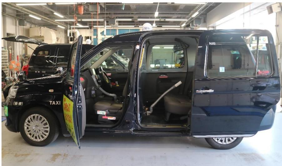
タクシー車両をベースに、運転席及び助手席の車内前方と後席の車内後方に隔壁を設置し、後方の空気が前方に循環しないよう、前方を陽圧、後方を陰圧となるよう空気をコントロールします。
